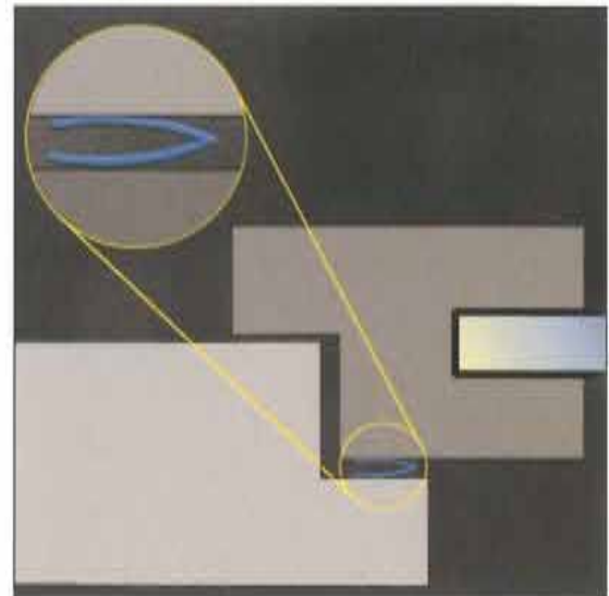
Abb. 4.13 V-Dichtungen für die nachträgliche Abdichtung von Fenstern.
