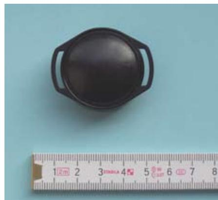
Passives Radonmessgerät mit Kernspurdetektor. Fotos: Haninger, mvdh.
